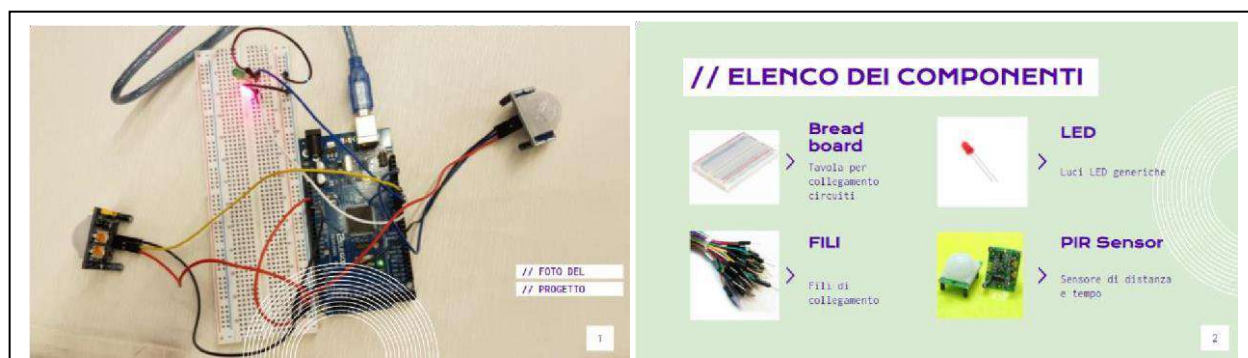
Figura 1 – Prototipo sensori e semafori di ingresso / uscita ambiente; componenti utilizzati
