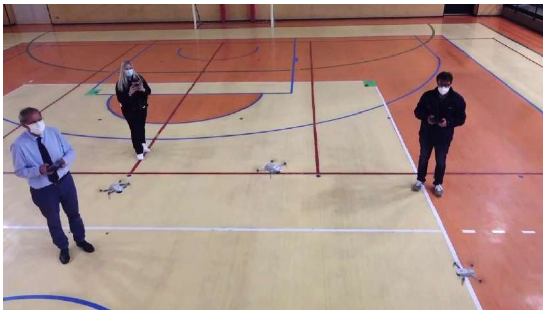
Figura 3 - Volo indoor di tre esemplari di APR DJI Mini 2. Il volo indoor è stata una ipotesi di studio che la sperimentazione ha vagliato, documentandone pro e contro. La ripresa è stata fatta da un quarto APR in volo, un DJI Mavic Mini.
