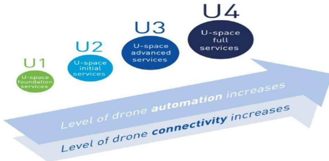
Figura 2 - Il piano di sviluppo dell'U-Space, in base allo sviluppo tecnologico previsto nei prossimi anni (fonte: EASA)
