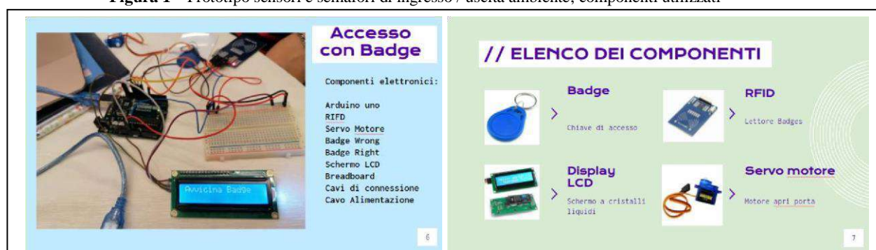
Figura 2 – Prototipo accesso con badge; componenti utilizzati
