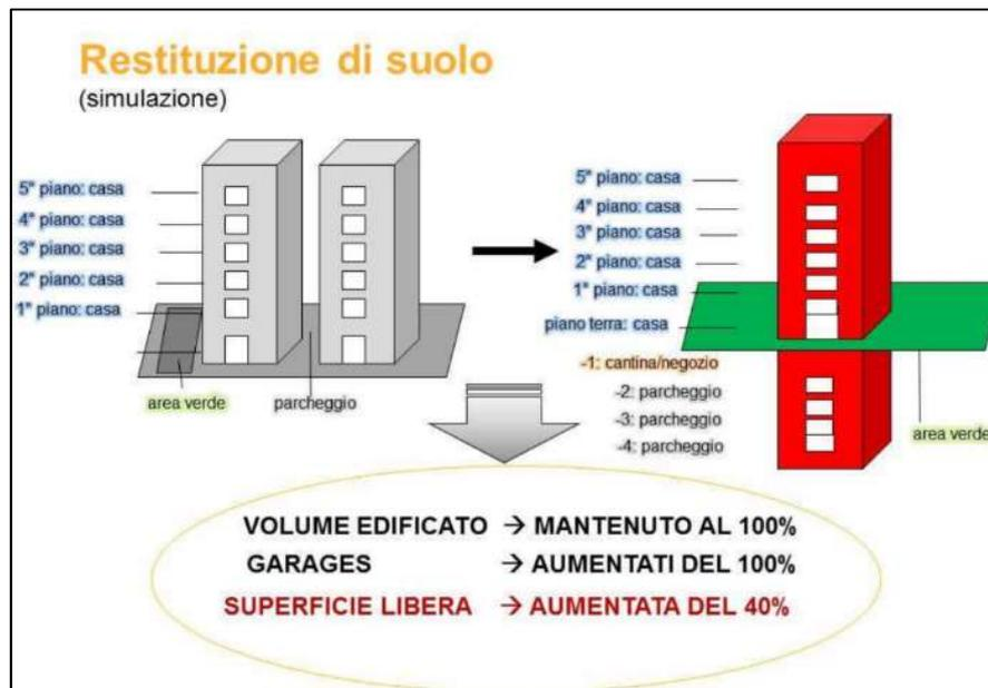
Figura 23 – Schema del metodo Rifo per la restituzione di suolo
