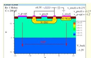
**Synopsys Raphael NXT** - Synopsys Raphael NXT è un estrattore tridimensionale in grado di valutare in modo accurato le capacità di strutture in silicio nel disegno di circuiti integrati. Il software Raphael NXT si basa su di un algoritmo di estrazione rapida ed è completato dal pacchetto Star-RCXT per l'estrazione di capacità 3D associate a linee critiche, celle e blocchi di interi circuiti. [figura software\_4.jpg]
