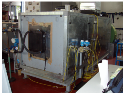
Fig. 5. Banco prova radiatori.
