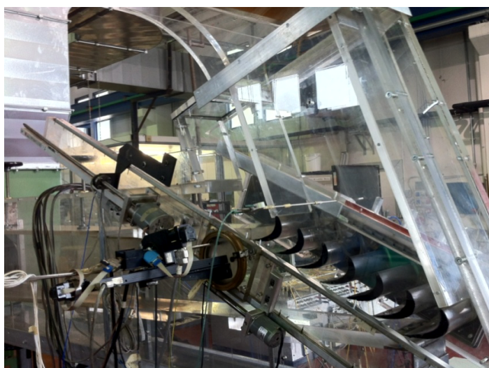
Fig. 2. Galleria del vento per schiera rotorica lineare.
