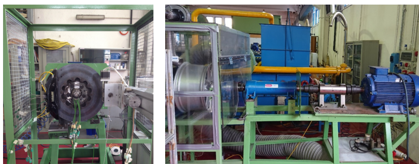
Fig. 6. Banco prova dischi freno.
