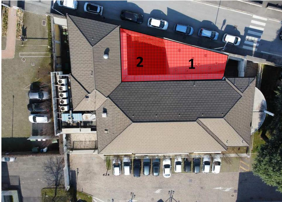
Area interessata dall'intervento strutturale composta da una copertura in acciaio esistente da rimuovere e reinstallare su nuove colonne in acciaio HEB160 (1) ed una parte di area verde oggetto del nuovo ampliamento (2)
